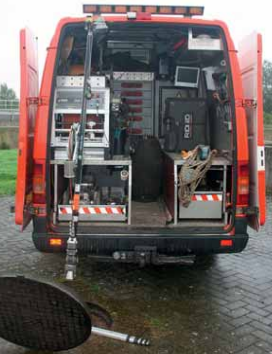
Klassieke putvideo-inspectie (directe inspectie) werd gedemonstreerd door de Nederlandse firma Van de Kreeke.
