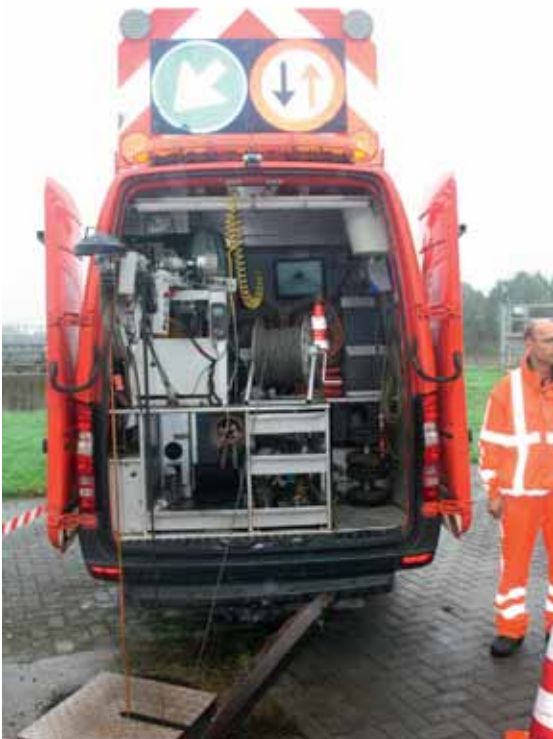
De Nederlandse firma Oomen kan via rioolradartechniek ondergrondse constructies opzoeken.
