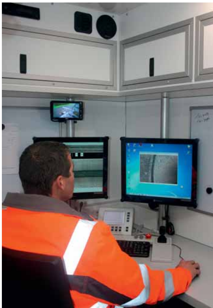
Bij VDV Cleaning gaf men duiding bij de Panorama-inspectietechniek (indirecte inspectie).
